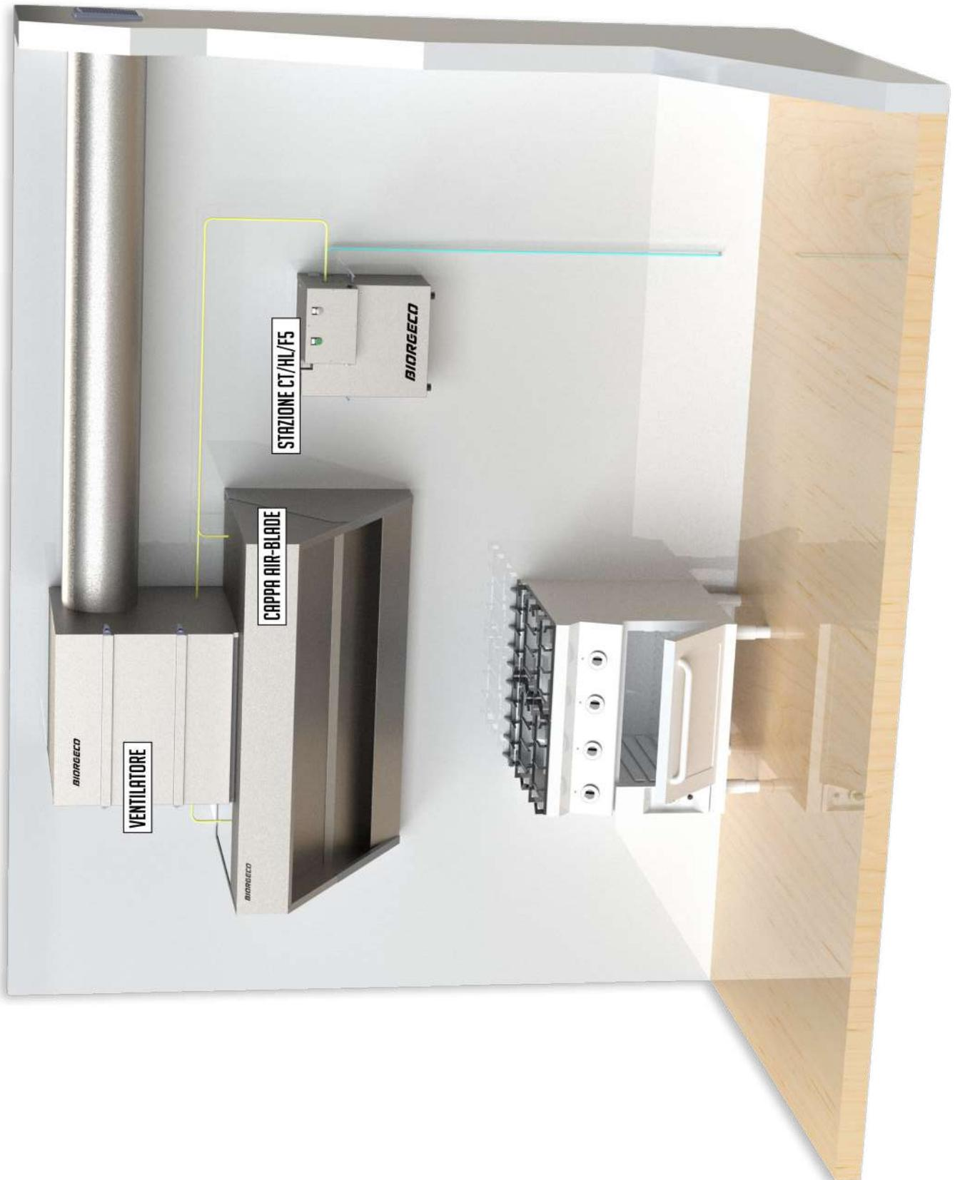
Diagramma di Installazione con Ventilatore posizionato fuori cappa
