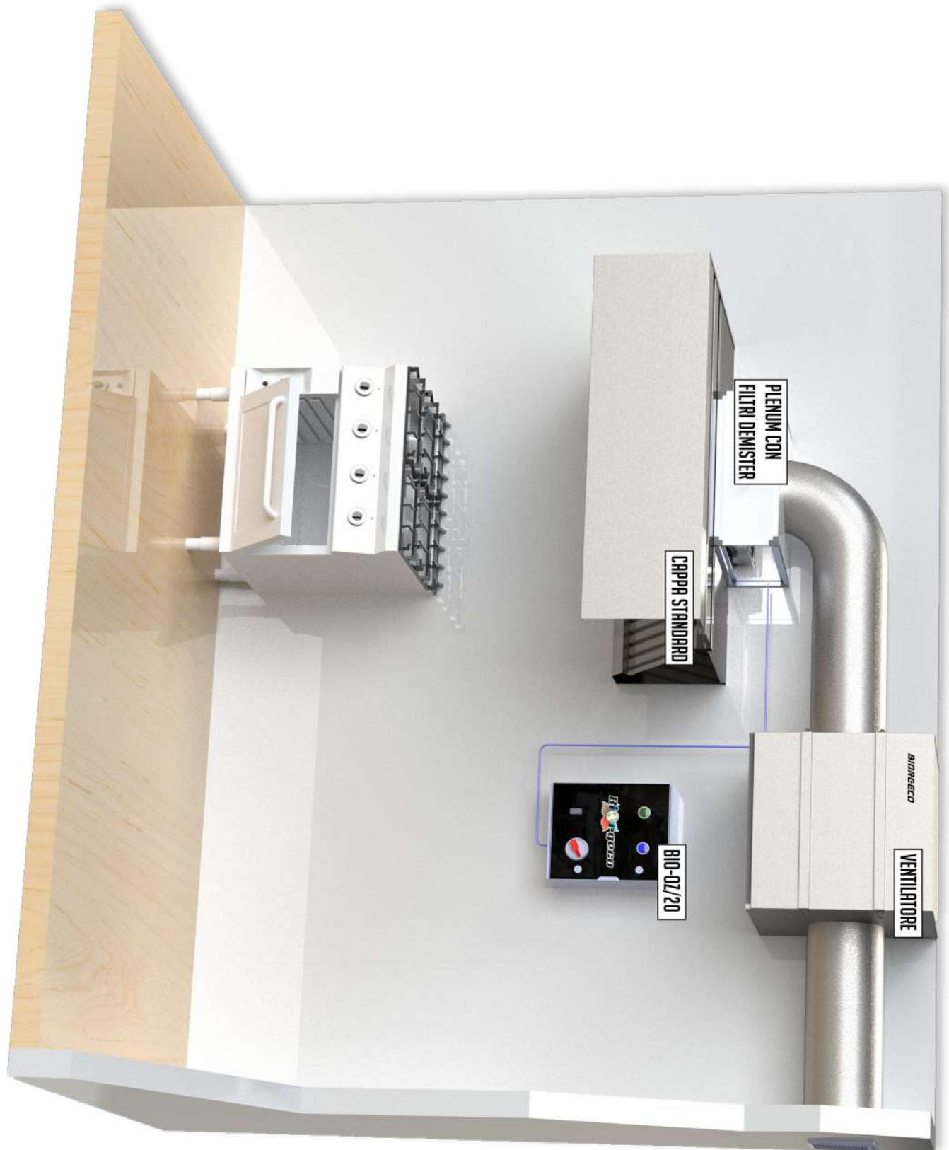
Diagramma di Installazione con Ventilatore posizionato sopra cappa
